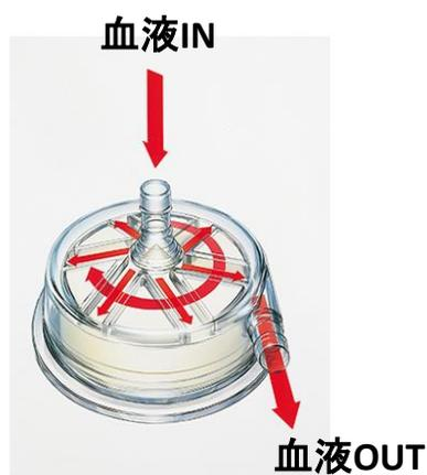
遠心ポンプは**遠心力**によって血液を吸い込み、送り出す機能を持ったデバイスである。
